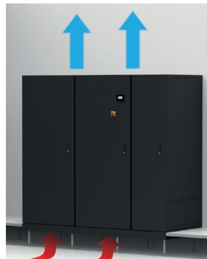
Воздухозабор снизу через фальшпол, закрытая передняя панель и восходящая подача воздуха.
