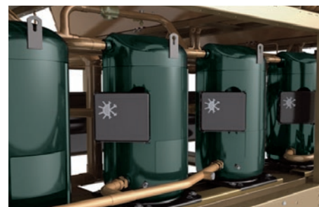
Конструкция с применением нескольких спиральных компрессоров в одной системе, позволяет снизить уровень шума при работе с частичной нагрузкой путем отключения неиспользуемых компрессоров.
